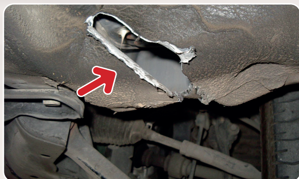
EXTERIOR: Orificio en los bajos del vehículo.
