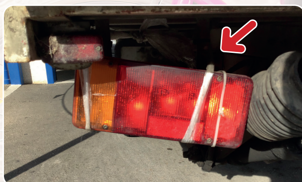
ALUMBRADO: Piloto trasero de señalización (luz de freno, de posición, indicadores de dirección, etc.) fijado incorrectamente con anclajes artesanales.
