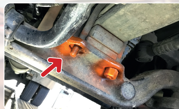
AMORTIGUADORES: Tuerca de fijación de ballesta de suspensión inexistente.
