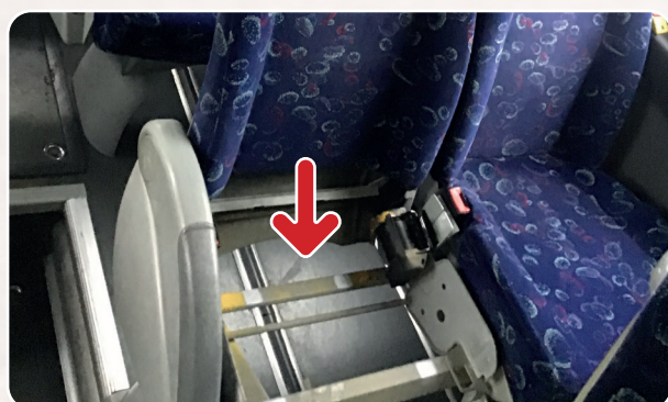
INTERIOR: Inexistencia del cojín del asiento de autocar.
