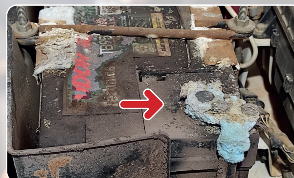
BATERÍA: Incorrecto estado de los bornes de la batería de arranque del vehículo.
