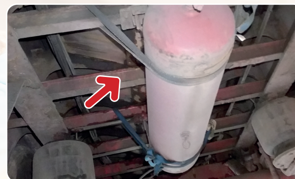
FRENOS: Depósito de aire comprimido del sistema de frenos de un vehículo industrial con fijaciones artesanales.
