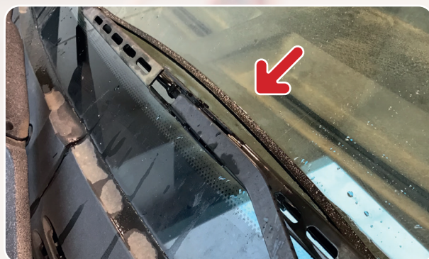
EXTERIOR: Elemento limpiador del limpiaparabrisas desprendido.
