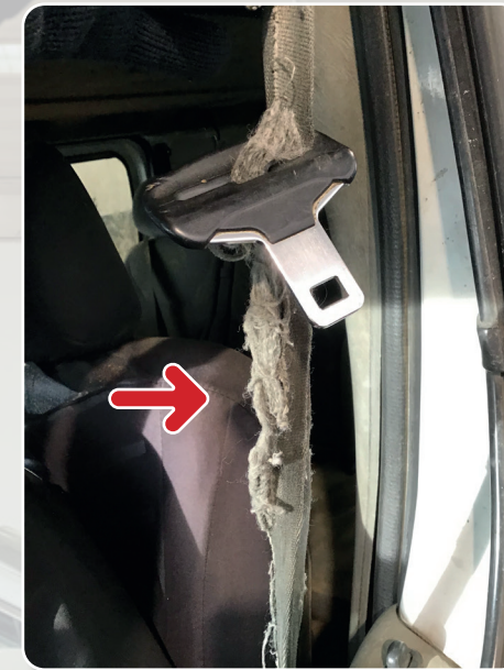
INTERIOR: Cinturón muy desgastado y deshilachado.
