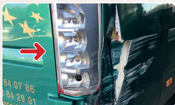
ALUMBRADO: Autocar con piloto trasero de señalización (luz de freno, de posición, indicadores de dirección, etc.) en incorrecto estado y con daños en carrocería.
