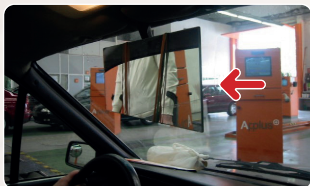
INTERIOR: Sustitución espejo retrovisor interior por otro ilegal y con fijaciones defectuosas.
